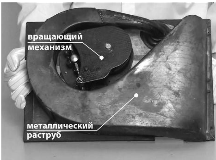
Внутреннее устройство патефона.
